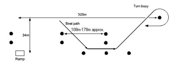
10.17:ホモロゲーション・ガイドライン・ジャンプ a) ジャンプコースは、測量により確認することを推奨する。(IWWF 25.08)
